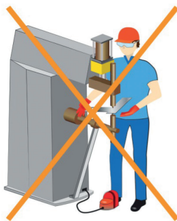
position de poste de travail à éviter
